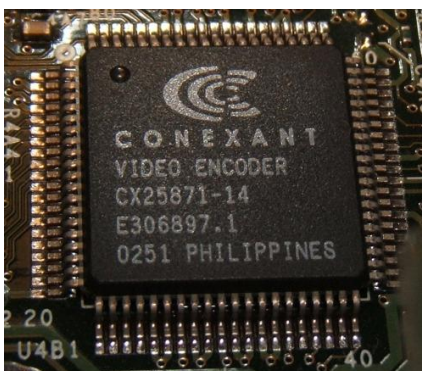
Exemple: Encodeur vidéo Conexant qui équipe les Xbox version 1.0 à 1.3
